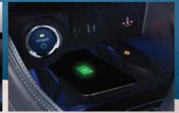
SẠC KHÔNG DÂY Tính năng sạc điện thoại không dây cho phép sạc điện thoại tương thích chuẩn sạc Qi đặt trong vùng sạc mà không cần đến ổ cắm hay dây sạc.
