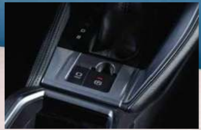
PHANH ĐỠ ĐIỆN TỬ Phanh đỗ xe điện tử hỗ trợ điều khiển tự động hệ thống phanh trên xe đảm bảo an toàn khi dừng, đỗ, loại bỏ tình trạng quên không kéo phanh hoặc kéo phanh chưa đủ. Nâng cấp hơn là hệ thống giữ phanh tự động, hỗ trợ xe tự đứng yên khi chờ đèn đỏ.
